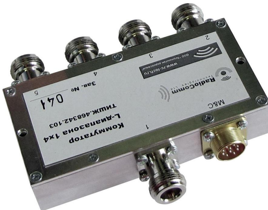
Рисунок 1.1.4.3 - Блок коммутатора UHF-диапазона 1x4 модель ТИШЖ.468342.103
